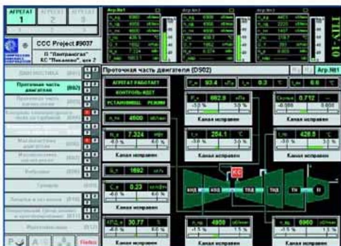
Экран диагностики проточной части двигателя
