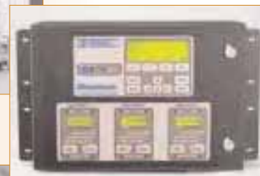
Рис. 8 Тройной микропроцессорный автомат безопасности
