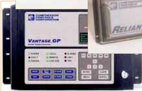
Рис. 6 Контроллер Паровой Турбины
